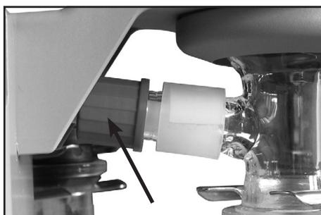
**Emissionskondensator EK demontieren:**
