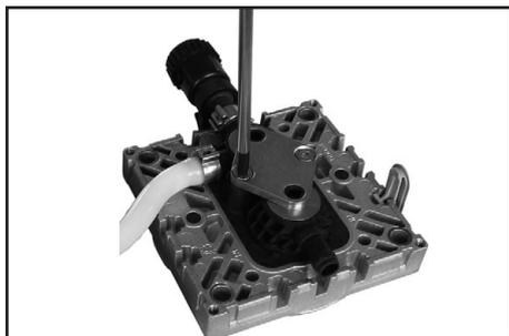
Spannpratzen auf den Ventilinseln lösen.
