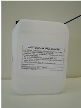
Flüssigabfall: basische Salzlösungen pH \geq 7 blauer Kabelbinder
