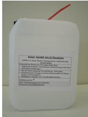
Flüssigabfall: saure Salzlösungen pH < 7 roter Kabelbinder
