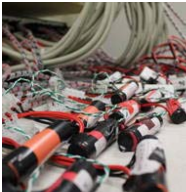
Messklemmen zum schnellen Kontaktieren von Batteriezellen im Batterieforschungslabor des Lehrstuhls für Elektrische Energiespeichertechnik (Bild: M. Müller / TUM).
